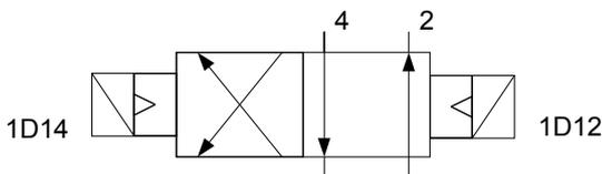
Pour désigner une commande il suffit d'accoler à la lettre D pour distributeur ou Y pour électrovanne un nombre indiquant le sens de circulation du fluide d'un numéro d'orifice à un autre.
