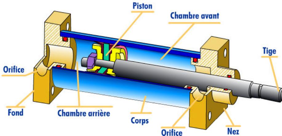
Ils transforment l'énergie d'un fluide sous pression en énergie mécanique (mouvement avec effort). Ils peuvent soulever, pousser, tirer, serrer, tourner, bloquer, percuter, abloquer ...
