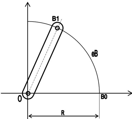
Pendant la rotation, le point B passe de B<sub>0</sub> à B<sub>1</sub>.
